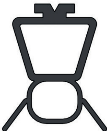
Ancien type de joint (matière EPDM) BAAN code: T09-020-20-0008
